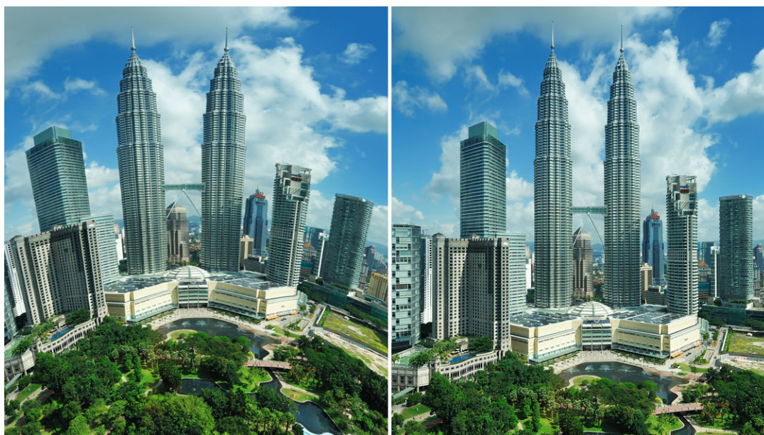
透过透镜校正，失真（左）可以减少（右）。
